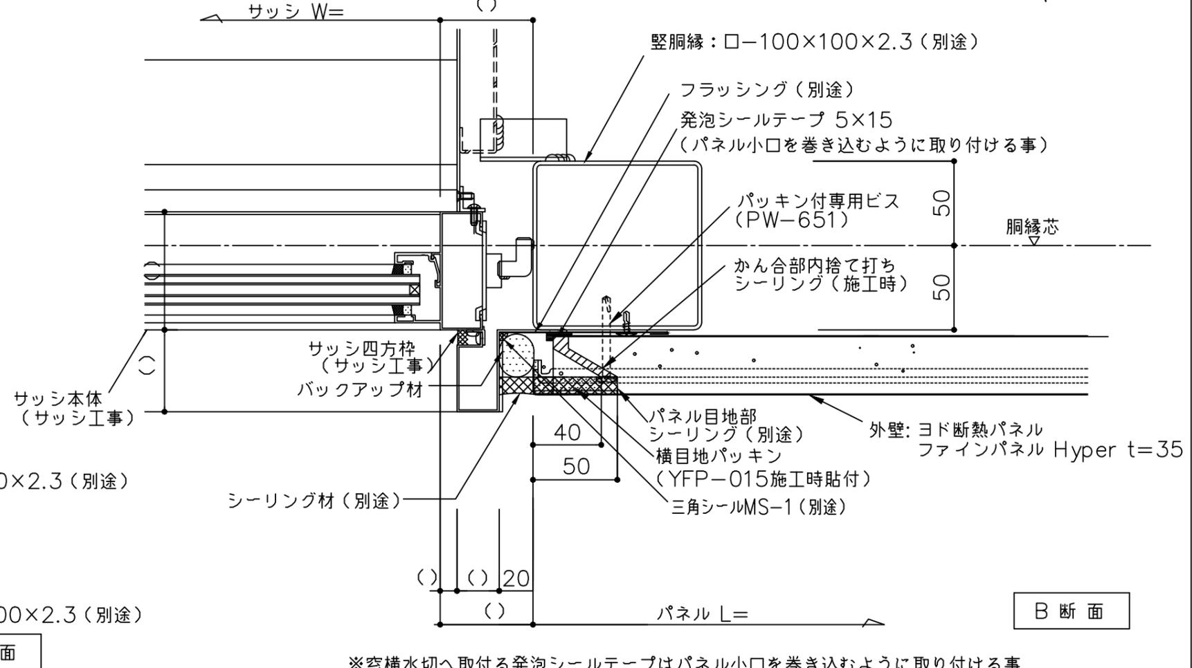
※窓横水切へ取付る発泡シールテープはパネル小口を巻き込むように取り付ける事
