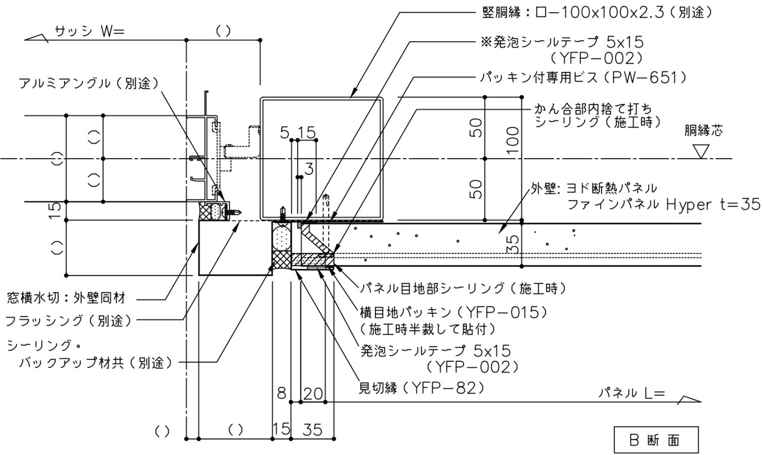
※窓横水切へ取付る発泡シールテープはパネル小口を巻き込むように取り付ける事
