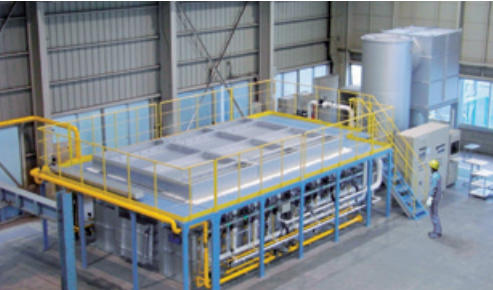
防耐火試験装置（水平炉）
