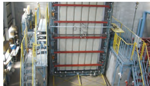
水密・耐風圧試験装置（大阪工場）
