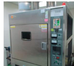
結露循環式カーボンアーク耐候試験機
