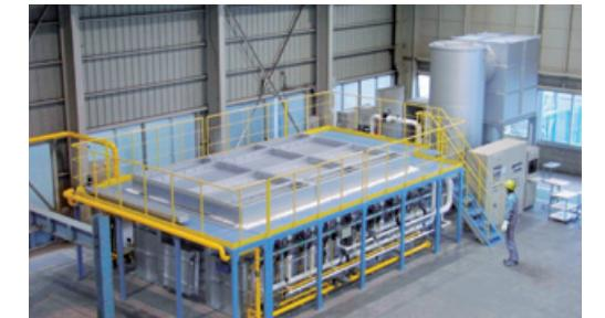
防耐火試験装置 (水平炉)
