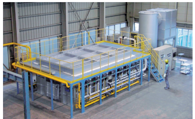
防耐火試験装置（水平炉）
