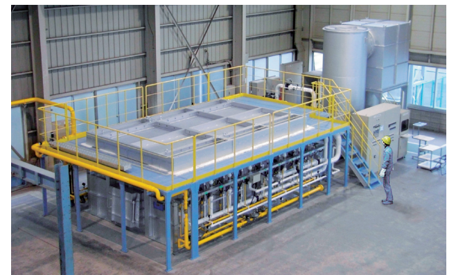
防耐火試験装置（水平炉）
