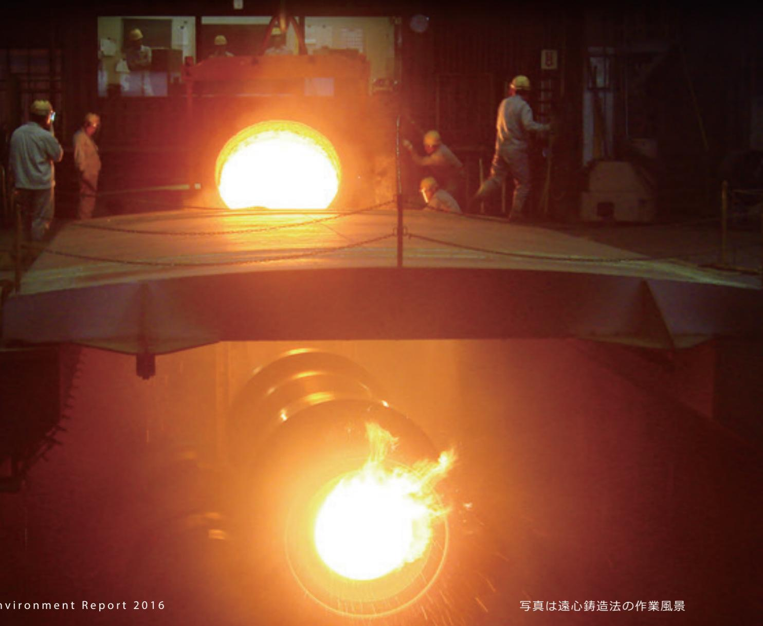
写真は遠心铸造法の作業風景
