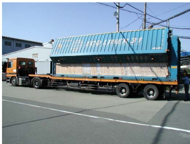
壁材を満載した 31 フィートコンテナ
