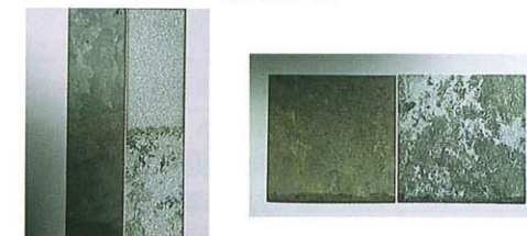
【写真-7】土中の耐食性(左:溶融亜鉛めっき鋼板、右:ガルバリウム鋼板)
